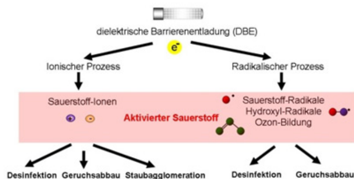
Abb. 1: Funktionsprinzip Ionisation
